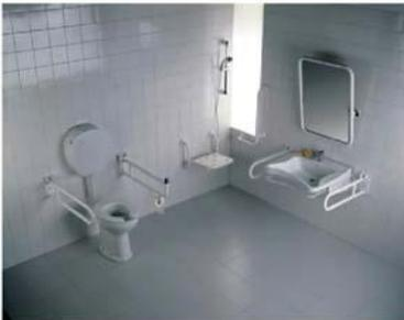
Para el **lavabo**, se recomienda que esté suspendido y no tenga pedestal, para facilitar la aproximación de la silla. Debe estar instalado a aproximadamente 80 cm de altura y el grifo será monomando, preferiblemente de mango alargado o automático. El borde inferior del espejo debe colocarse a una altura máxima de 1 metro para que
